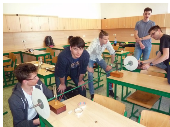
Obr. 2 Měření rychlosti střely pomocí dvojice rotujících kotoučů.
