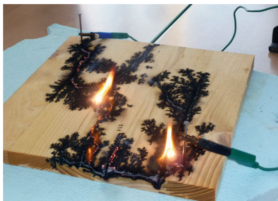
Obr. 3 Vytváření Lichtenbergových obrazců na dřevěné desce.
