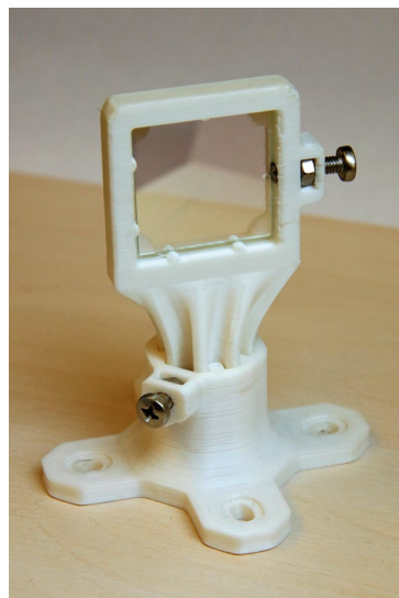
Obr. 14 Zkompletovaný modul děliče paprsků.
